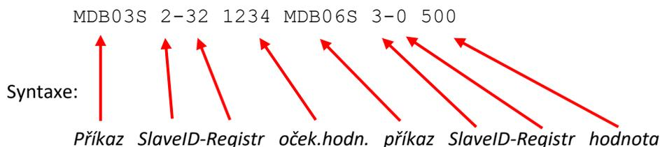
Význam: Přečti 2 Byte počínaje adresou 32 ze zařízení se SlaveID=2 pomocí Modbus funkce 03. Přečtené 2 Byte převed' na znaménkové celé číslo a to porovnej se zadanou hodnotou 1.234. Pokud se čísla rovnají, spust' navazující příkaz (MDB06 3-0 500).
