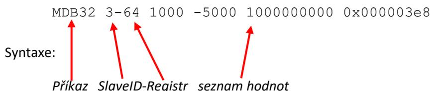
Význam: Zapiš hodnotu 1000 do registrů 64 a 65, -5.000 do registrů 66 a 67, 1.000.000.000 do registrů 68 a 69 a 1000 do registrů 70 a 71 v zařízení se SlaveID=3 pomocí Modbus funkce 16.
