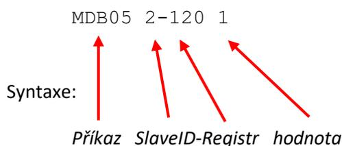
Význam: Zapiš logickou 1 (=ZAPNUTO) do registru s adresou 120 v zařízení se SlaveID=2 pomocí Modbus funkce 05.
