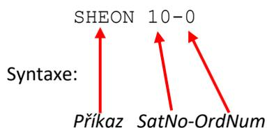
Význam: Zašli na IP adresu (např. 10.0.1.81 podle definice satelitu č. 10 v seznamu IP adres) příkaz zapnutí prvního logického zařízení (URL: <http://10.0.1.81/relay/0?turn=on>)
