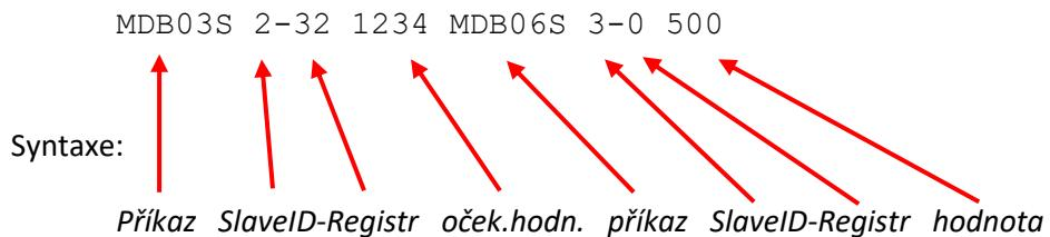
Význam: Přečti 2 Byte počínaje adresou 32 ze zařízení se SlaveID=2 pomocí Modbus funkce 03. Přečtené 2 Byte převeď na znaménkové celé číslo a to porovnej se zadanou hodnotou 1.234. Pokud se čísla rovnají, spusť navazující příkaz (MDB06 3-0 500).
