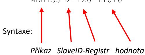
Význam: Zapiš logickou 0 do registru 120, 1 do 121, 0 do 122 a 1 do 123 a 124 v zařízení se SlaveID=2 pomocí Modbus funkce 15.
