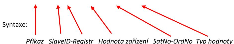
Význam: Zapiš aktuální hodnotu ceny ze zařízení 1-1 (speciální indikátor pro měření spotové ceny) do registru s adresou 32 v zařízení se SlaveID=1 pomocí Modbus funkce 06.
