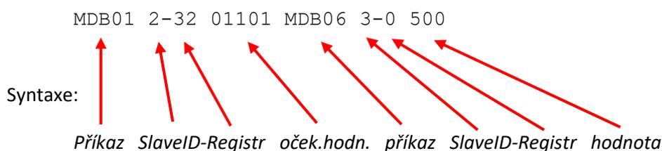
Význam: Přečti 16 bitů počínaje adresou 32 ze zařízení se SlaveID=2 pomocí Modbus funkce 01. Přečtených 16 bitů porovnej se zadanou **binární** hodnotou **zprava**. Pokud se všechny uvedené bity rovnají, spust' navazující příkaz (MDB06 3-0 500).
